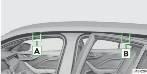
В зависимости от комплектации поперечины крыши могут быть закреплены в точках крепления **A** и **B** или на рейлингах крыши.
