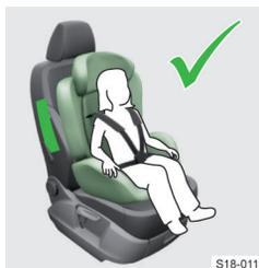
Между ребёнком и областью раскрытия боковой подушки должно быть достаточно места, чтобы боковая подушка при срабатывании могла обеспечить максимальную защиту.
