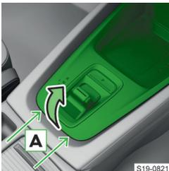
› Вставьте шлицевую отвёртку или аналогичный инструмент в зазор в области стрелок **A**.
