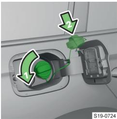
› Поверните пробку заливной горловины в направлении стрелки и снимите её.
